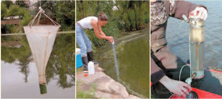
Figure I : Dispositifs de prélèvement utilisés depuis la berge (de gauche à droite ci-dessus, filet à plancton et tube échantillonneur) ou depuis un bateau (ci-contre, bouteille de prélèvement de Van Dorn). (Photos M. Leitao, Bi-Eau).
